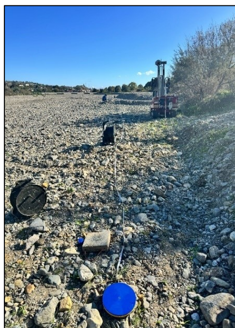
Figura 27 Configurazione profilo sismico a RIFRAZIONE
