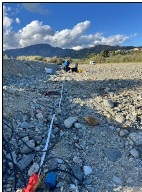
Figura 28 Configurazione profilo sismico a RIFRAZIONE
