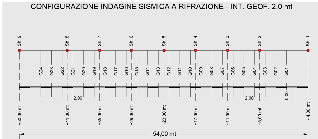
Figura 28 Configurazione profilo sismico a RIFRAZIONE
