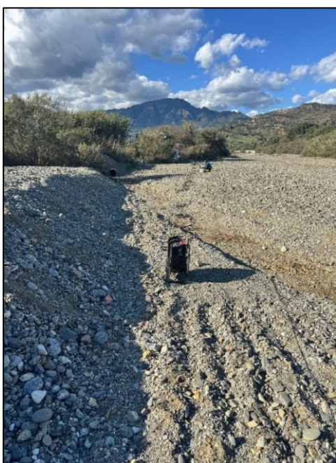
Figura 27 Configurazione profilo sismico a RIFRAZIONE
