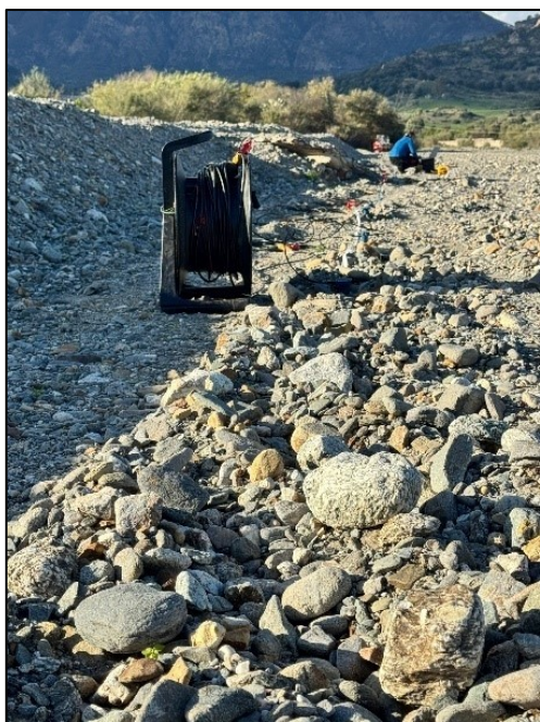
Figura 28 Configurazione profilo sismico a RIFRAZIONE
